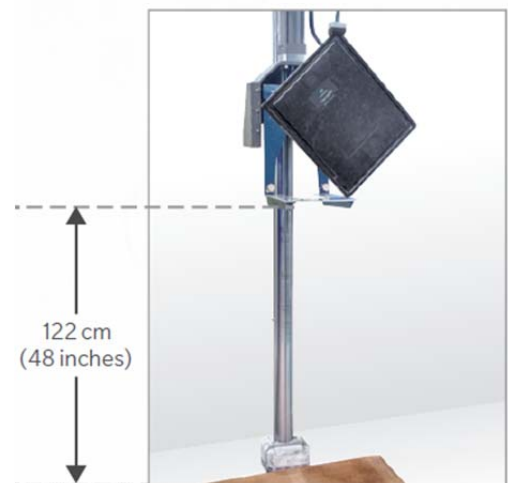
図2 MIL 試験の様子
