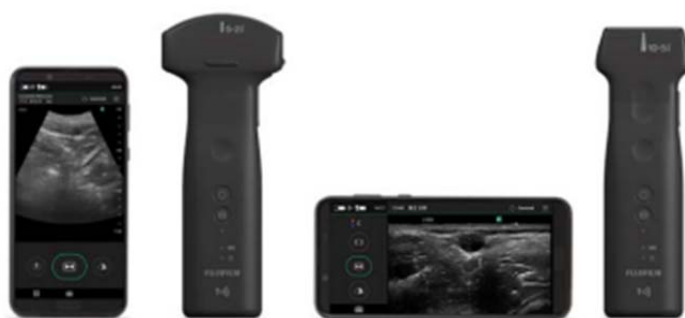
(左:コンベックスプローブ 右:リニアプローブ) 図1 ワイヤレス超音波画像診断装置「iViz air」
