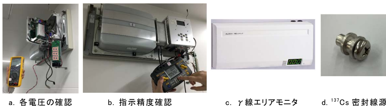
図3 エリアモニタの点検および校正の例
