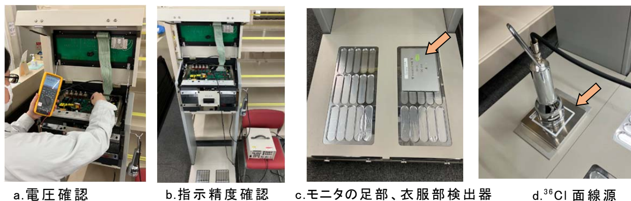
図7 ハンドフットクロズモニタの点検・校正の例
