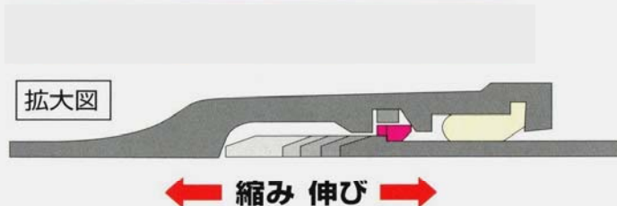
耐震性能を有する継手の例(ダクトイル铸铁管耐震型継手)
