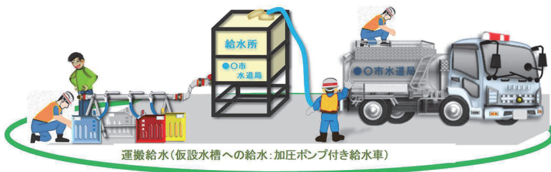
図1-2 仮設水槽による給水
