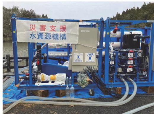
可搬式浄水装置（独）水資源機構
