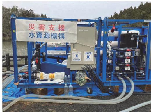
可搬式浄水装置 (独)水資源機構
