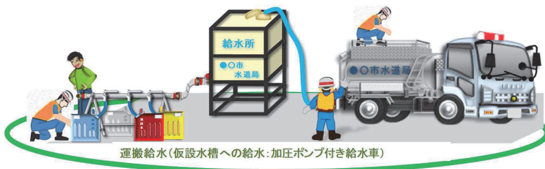
図1-2 仮設水槽による給水
