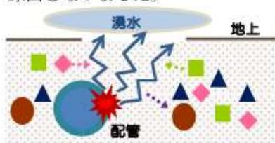
そこで、地域内の様々な土壌を調査し、土壌の影響を受けず、漏水判定の指標となる水質項目を探索しました。そして次のようにイオンクロマトを用いた漏水元の判定方法を確立しました。
