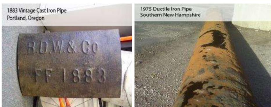
図 3-3 1883 年製の鑄鉄管 (左) と 1975 年製のダクタイル鑄鉄管 (右)
