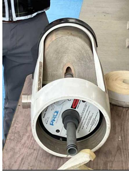
右：逆浸透膜装置の中身（紙が積層している）
