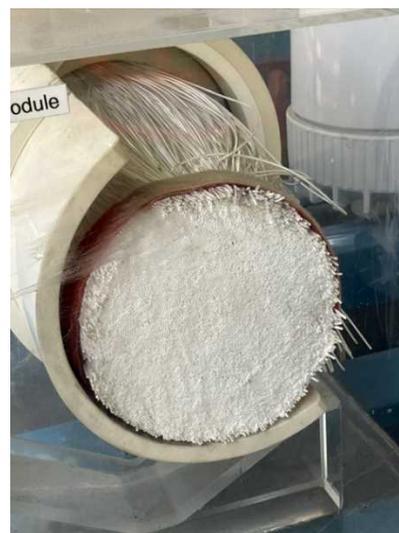
写真 16 左：膜ろ過装置 右：膜ろ過装置の中身
